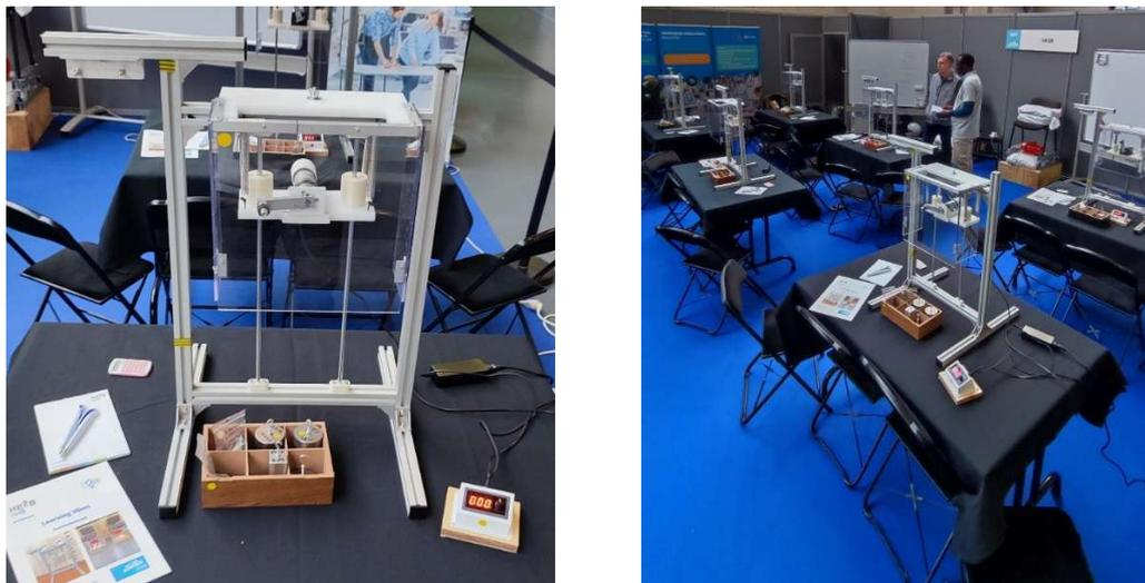
Figure 2 Les postes d'expérimentation des phénomènes vibratoires
